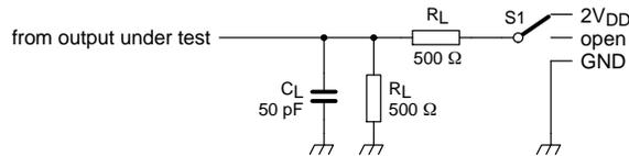
**Figure 17. Load Circuit**
