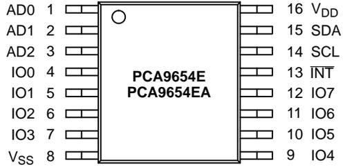
Figure 3. SOIC16 / TSSOP16
